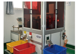
光学筛选机 CCD Optical Screening Machine
